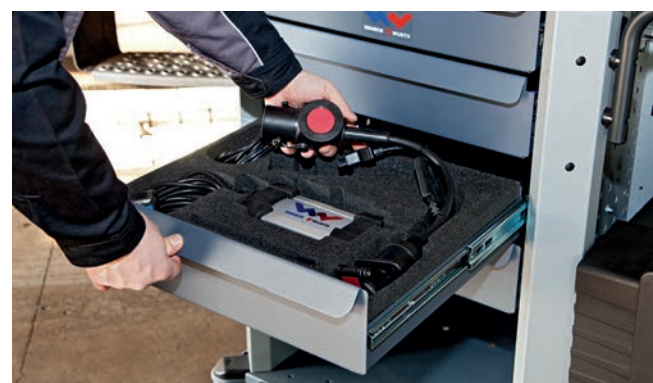
4 robusne ladice sa teleskopskim vodicama za potpuno izvlačenje.
