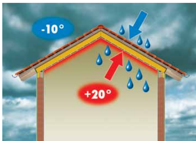
Otparivanje objekta i kondenzacija
